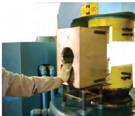
Монтаж матриц в пресс серии «Advanced»
